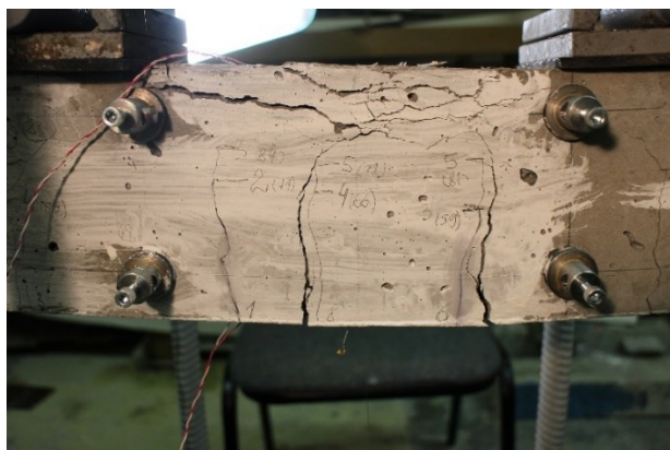
Рис. 6. Характер разрушения эталонных образцов А1 и А2
