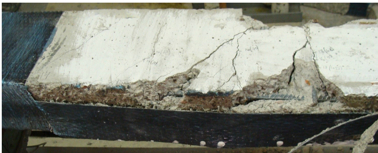
Рис. 4. Характерное разрушение образца Б-2-2
