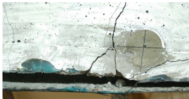
Рис. 11. Поверхность разрушения, усиливаемых образцов
