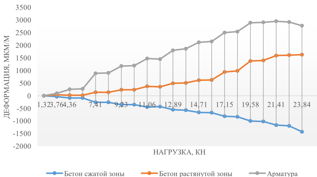
Рис. 7. Графики зависимости «нагрузка-деформации» для образцов первой партии (без усиления)
