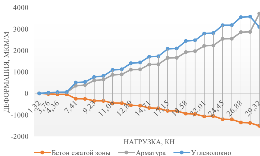
Рис. 13. Графики зависимости «нагрузка-деформации» для образцов второй партии (Б1 и Б2)
