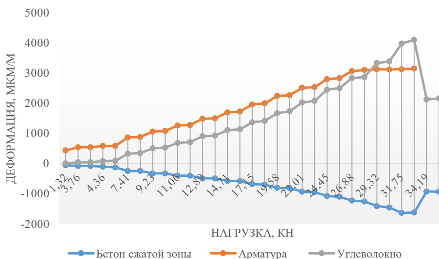
Рис. 12. Графики зависимости «нагрузка-деформации» для образцов второй партии (Б1 и Б2)
