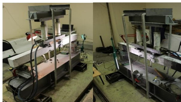
Рис. 5. Общий вид испытания до усиления углеволокном и после усиления
